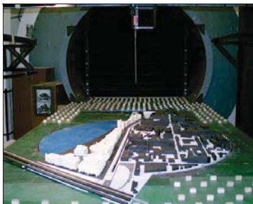
12. ábra: A Millenniumi Városcsopont modellje a szélsatornában
